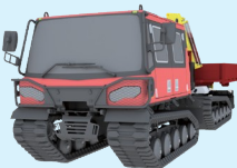
Platforma z dźwigiem
