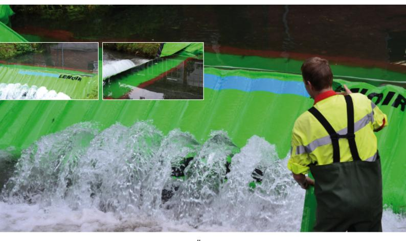
Optional mit integrierter Öffnung für kontrolliertes Abfliessen des Wassers bei Öl- und Chemie-Unfällen
